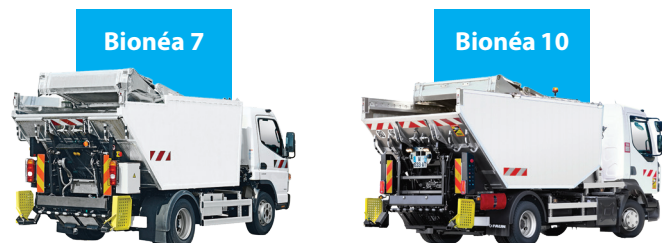
Bionéa 7 (volume 7 m 3 pour 4 tonnes de biodéchets) et Bionéa 10 (volume 10 m 3 pour 5,5 tonnes de biodéchets).
